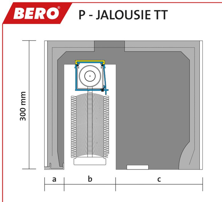
Selbsttragender Jalousiekasten aus bewehrtem BEROpor-Leichtbeton mit fest einbetonierten Porenbetonblenden und zur **Aufnahme einer Außenjalousie**.
